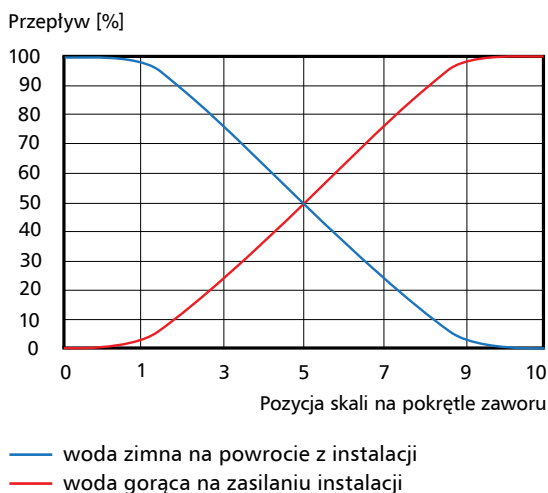
Wykres przepływu w zależności od stopnia otwarcia zaworu
